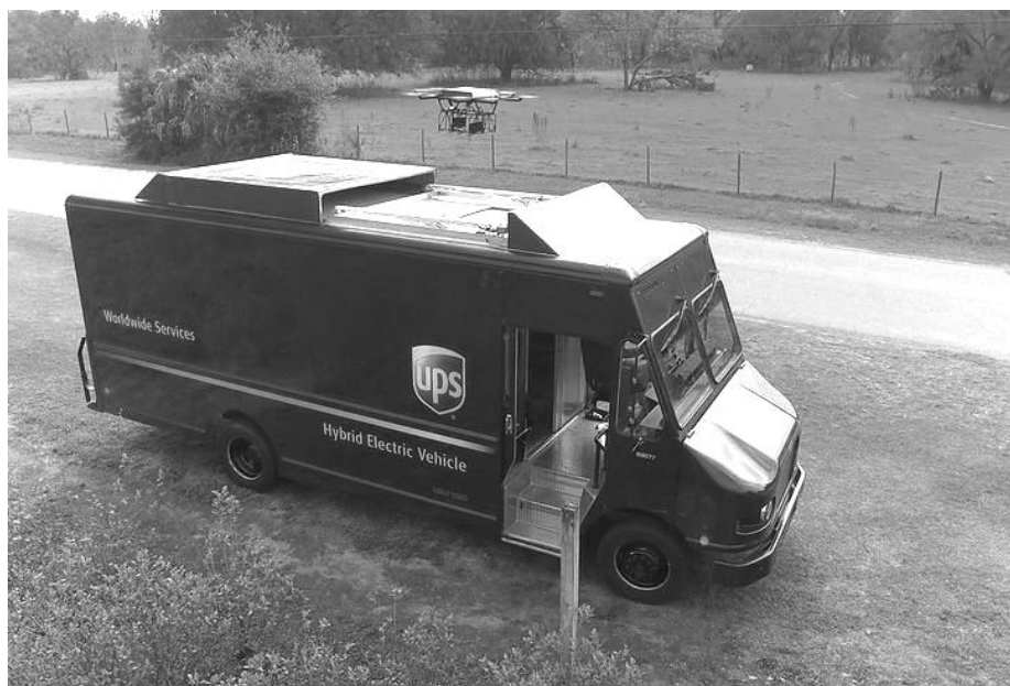
Rys. 5. Hybrydowa ciężarówka firmy UPS będąca bazą dronów [8]
